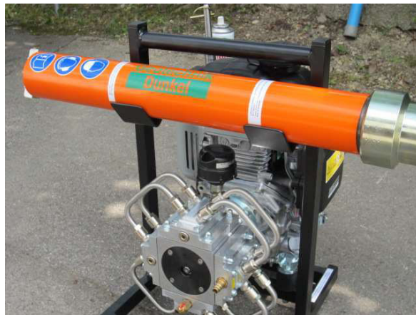
Slika 7 - dinamični penetrometer PR.13
